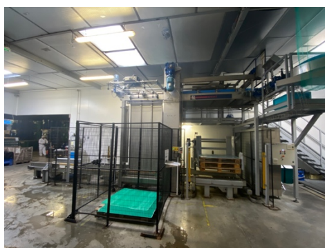
32 - machine séparation des bocaux
