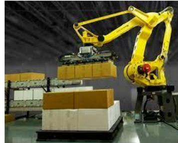
19- robot articulé FANUC M-410iC/500
