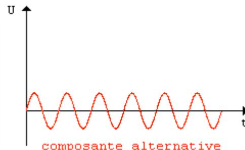
C'est cette opération de filtrage qu'effectue un oscilloscope en mode AC (ou CA).
