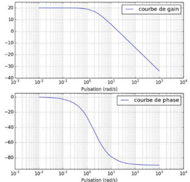
Pour  $\omega \ll \omega_0$  et  $\omega \gg \omega_0$ , on peut confondre les diagrammes de Bode asymptotiques et réels.
