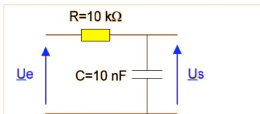
➤ Un filtre passe-haut dont la fréquence de coupure  $f_c$  est telle que  $f_c \ll F$  aura pour effet de ne garder que la composante sinusoïdale en sortie :
