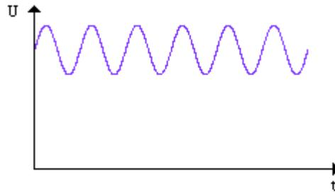
➤ Un filtre passe-bas dont la fréquence de coupure  $f_c$  est telle que  $f_c \ll F$  aura pour effet de ne garder que la composante continue en sortie :
