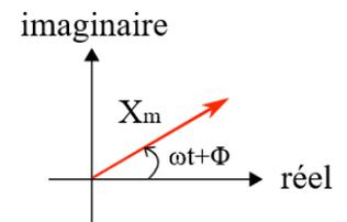
Figure 5 - Représentation de Fresnel d'un signal sinusoïdal
