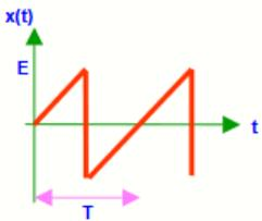
$$x(t) = \frac{2E}{\pi} \left[ \sin(\omega t) - \frac{\sin(2\omega t)}{2} + \frac{\sin(3\omega t)}{3} + \dots \right]$$
