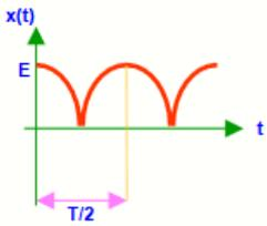
$$x(t) = \frac{2E}{\pi} \left[ 1 + \frac{2 \cos(2\omega t)}{3} - \frac{2 \cos(4\omega t)}{15} + \dots \right]$$
