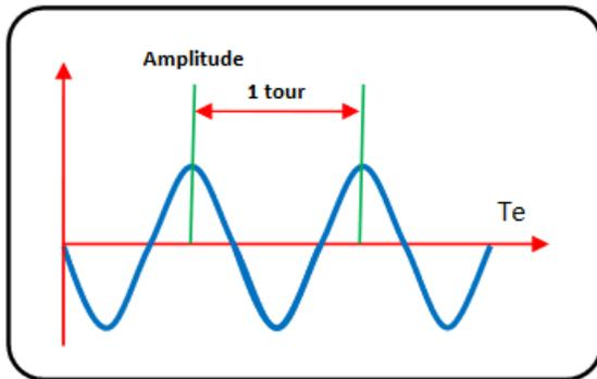
Figure 4.1 : Signal vibratoire sinusoïdal généré par un balourd
