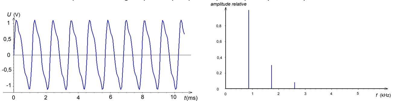
Le pic de **plus basse fréquence** (non nulle) est appelé **fondamental**. Sa fréquence correspond à la fréquence du signal périodique.
