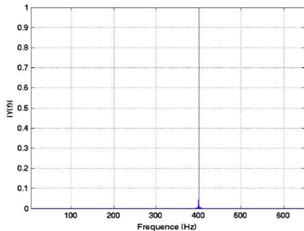
La fréquence du pic (400 Hz sur l'exemple) correspond à la fréquence du signal sinusoïdal et son amplitude correspond à celle du signal sinusoïdal.
