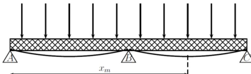
On démontre que le point situé entre B et C où la déformation est maximum, a une abscisse  $x_m \neq 1$  qui est solution de l'équation :  $32x^3 - 156x^2 + 240x - 116 = 0$
