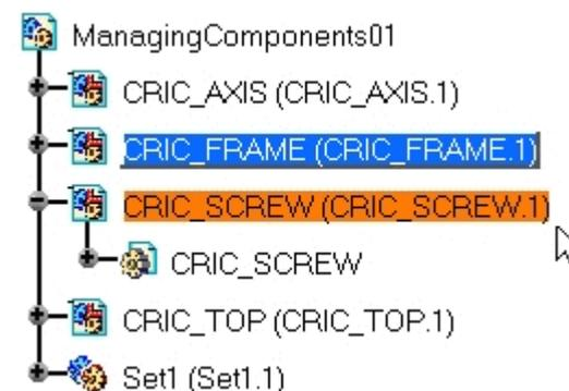
Lorsque vous définissez une contrainte, aucune règle ne définit le composant fixe et le composant déplacé lors de la sélection. Si vous voulez fixer un composant, utilisez la commande Fixer.
