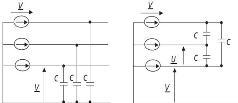
En étoile :  $Q_C = -3 \cdot C\omega \cdot V^2$  . En triangle :  $Q_C = -3 \cdot C\omega \cdot U^2 = -9 \cdot C\omega \cdot V^2$
