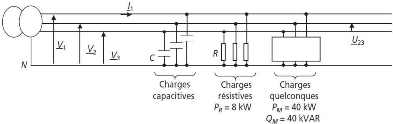
Le circuit de charge de ce système est constitué de charges équilibrées classées par type : charge capacitive, charges résistives et charges quelconques.
