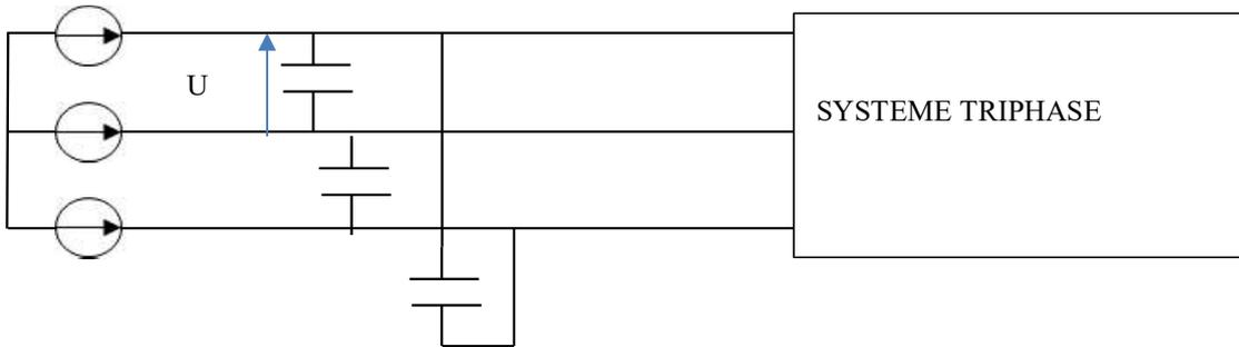
2) Dans le cas des capacités  $C'$ , câblées en triangle, le calcul est le même sauf que les trois condensateurs sont sous la tension  $U = \sqrt{3} \cdot V$ . En conséquence, ils consomment la puissance réactive :  $Q_{C'} = -3 \cdot C' \omega U^2 = -9 \cdot C' \omega V^2$ .
