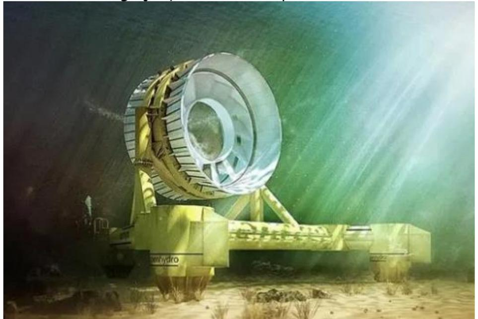
La puissance cinétique d'un fluide traversant un disque est proportionnelle à sa surface, donc au carré de son diamètre, à la masse volumique du fluide et au cube de sa vitesse.
